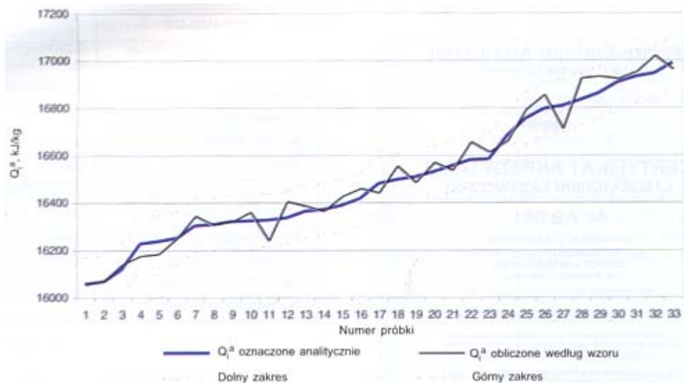
Rys. 3. Porównanie wartości opałowej obliczonej z uwzględnieniem zawartości wodoru oznaczonej eksperymentalnie i obliczonej według opracowanego wzoru
